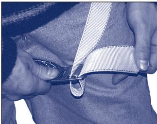
**Hebilla tipo paracaídas:** pase la cincha por debajo de la hebilla, sobre el rodillo y nuevamente por abajo, entre el rodillo y la estructura. Tire de la cincha para apretarla. Debe haber 7,6 cm (3 pulgadas) de cincha después de la hebilla.
